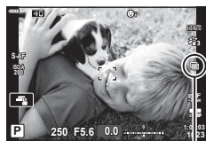
Камера в процессе подготовки к режиму «Съемка в супер-HD» (мигает)
